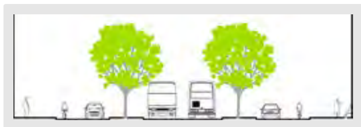
Nivå 3 - Fordelingsgater: Dette snittet er aktuelt for fordelingsgatene med kollektivtransport. Snittet prioriterer fremkommelighet for kollektivtrafikken med midtstilt trase. Alle trafikanter har egne arealer.
