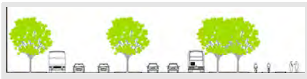
Nivå 1 - Stamvei: Motorveiutforming strammet opp med trerekker. Planskilte krysninger. Veien opprettholder barrierenvirkningene, men gir et grønnere uttrykk. Krever god buffersone mellom fotgjengere og syklistene. For enkelte strekninger av nivå 1 vil det være aktuelt med flere kjørefelt for bil.
